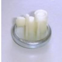
Der Membranregler dient, um die Pulsationen der Pumpe im Wasserkreislauf zu dämpfen. Er verringert das Pumpengeräusch. Er sollte sich frei durchblasen lassen. Der Membranregler ist schadhaft, wenn er sich nicht frei durchströmen lässt oder undicht ist.
