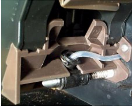
Das Drainageventil wird vom Magnetschalter (M) angesteuert. Der Magnetschalter wirkt dabei auf das weiße, federbelastete Teil im Bild links. Die Rückstellung erfolgt über den Federdruck der Feder.
