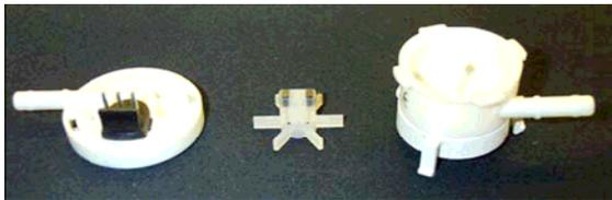
Dieses signalisiert der Maschinenlogik die durchgelaufene Wassermenge bei Bezug oder beim Spülvorgang. Das Flowmeter gibt dabei über einen drehenden Impeller mit 2 Magneten per Reedkontakt Signale an die Logikeinheit. Jedes Signal entspricht einer definierten Wassermenge. Die Maschine rechnet diese
